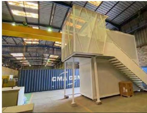
Au fur et à mesure de la production des structures, une tête de série a été envisagée pour simuler et valider en parallèle toute l'installation technique et l'habillage.
