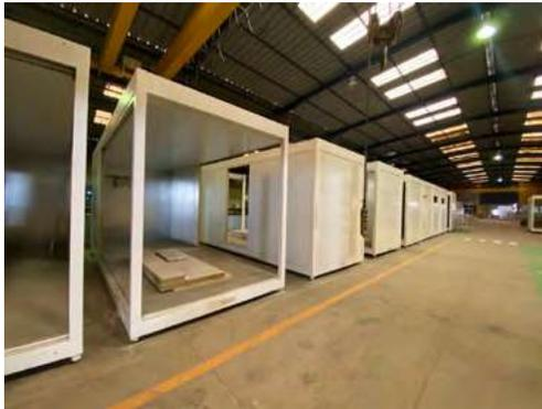
Pour déployer rapidement le bâtiment, le choix s'est porté sur 38 modules fabriqués et montés en totalité en usine.
